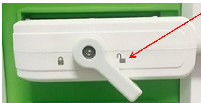
Figure 11 : Bouton de verrouillage du connecteur de la sonde déverrouillé
